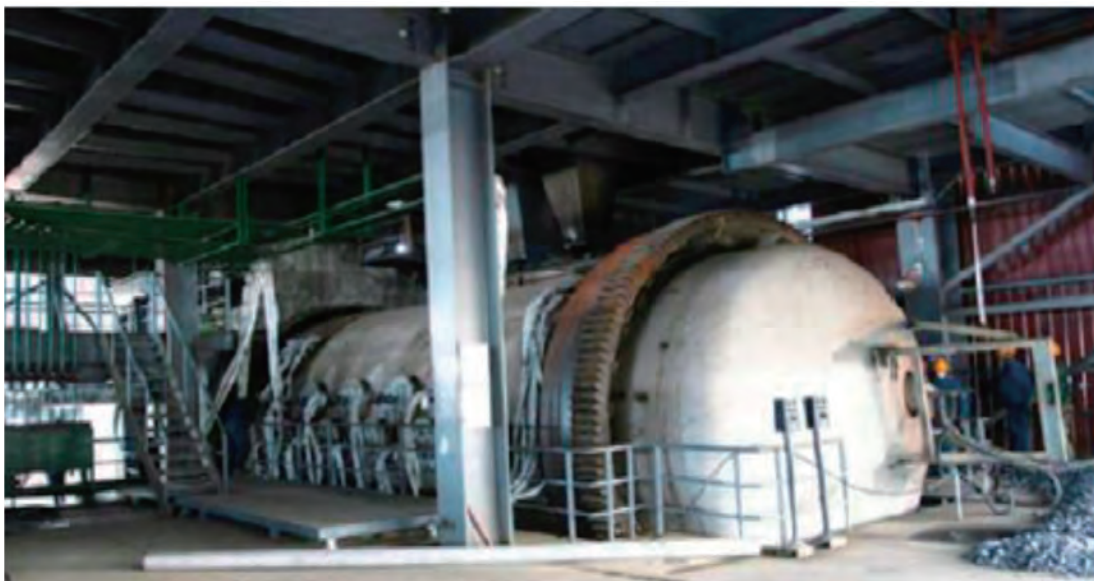
図3-3. 東営方園における底吹炉の写真 (SKSプロセス炉) (Central South UniversityのX. Guo氏の資料より抜粋)
